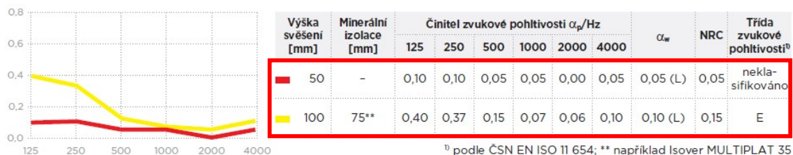
Obr. 2 Činitel zvukové pohltivosti \alpha akustického podhledu Base 31 – převzato z technické dokumentace RIGIPS poskytnuté výrobcem
